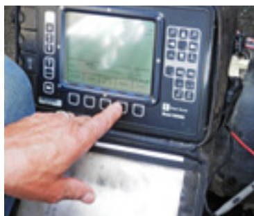
Messgerät zur Bestimmung der Drahtlänge: Laufzeitmessgerät
